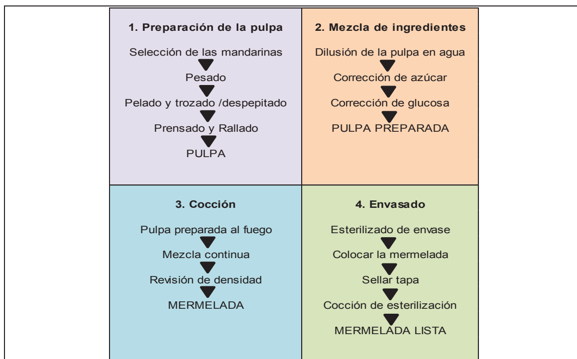
Figura 26. Proceso de preparación de la mermelada.
