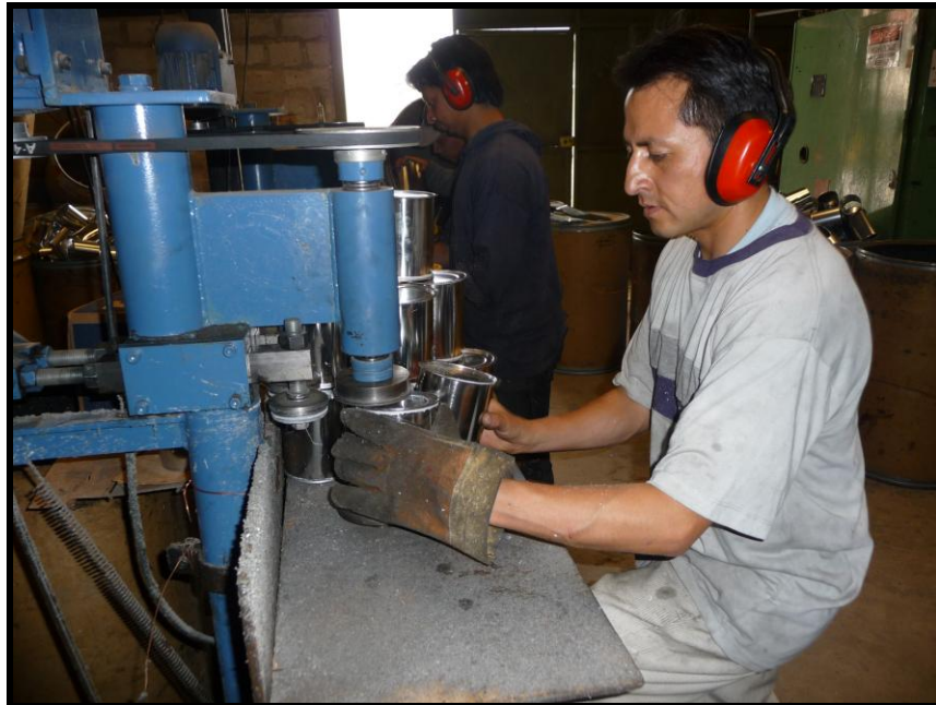
Fotografía N°5.6: Uso de Equipo de Protección Personal
