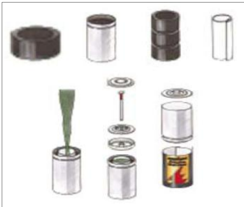
Imagen 2.2. Construcción de la Pila
