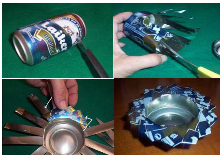
FOTOGRAFIAS 4.85, 4.86, 4.87 y 4.88 Fabricación cenicero artesanal con lata de aluminio
