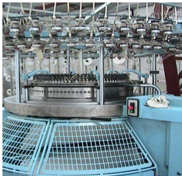
Foto 2.1 Máquina tejedora JUMBERCA- ESPAÑA Autor: Piedad Guevara
