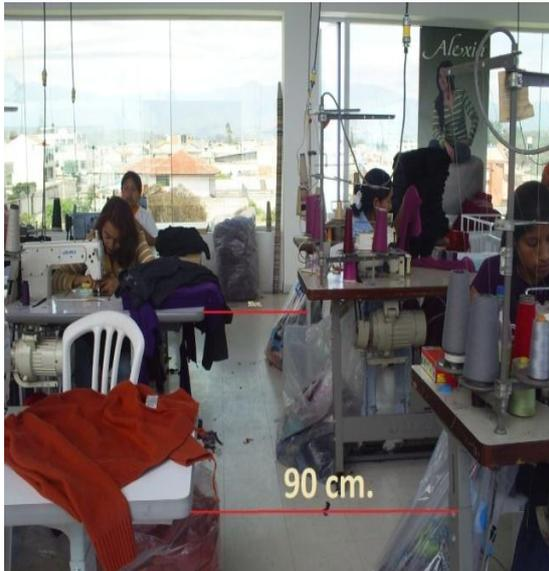
Separación entre máquinas
