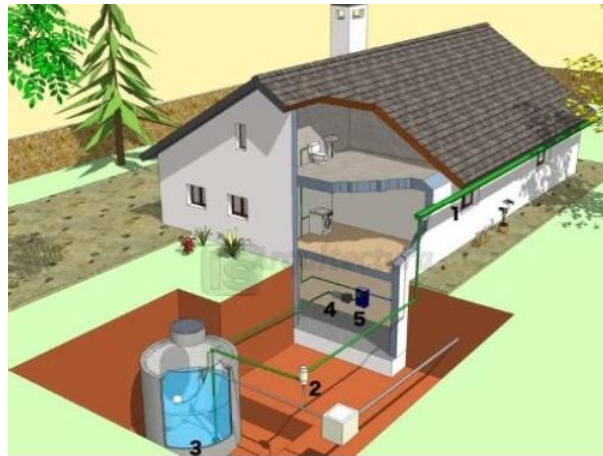
Figura 22: Instalaciones de un SCAPT
