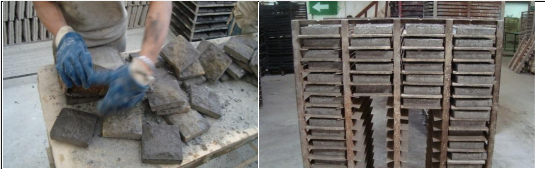
Figura 6: Proceso de desmolde del material
