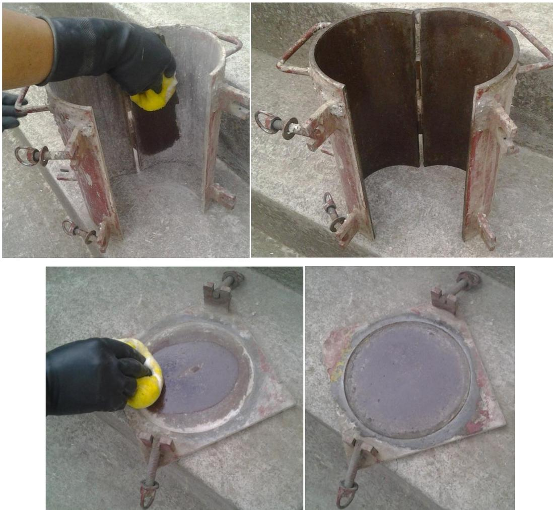
Figura 48. Expansión de una capa de diesel sobre la pared interna de los moldes cilíndricos y base
