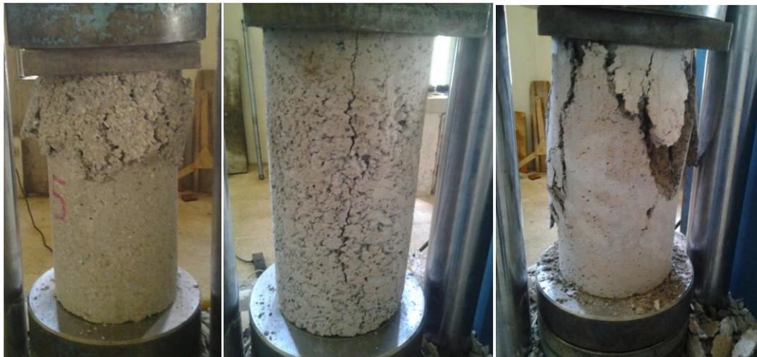
Figura 60. Ensayos de compresión sobre muestras de materiales experimentales en los laboratorios de la EPN
