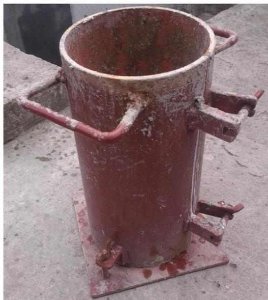
Figura 15. Molde de núcleos o cilindros de hormigón
