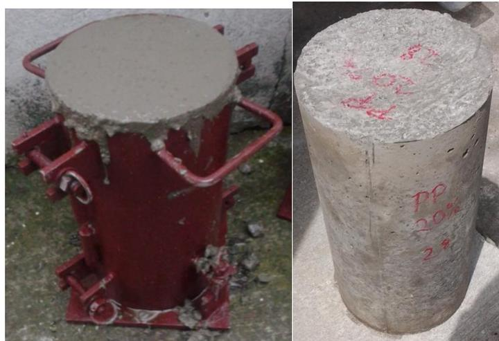
Figura 49. Muestra de hormigón encofrada y desencofrada 7 días después
