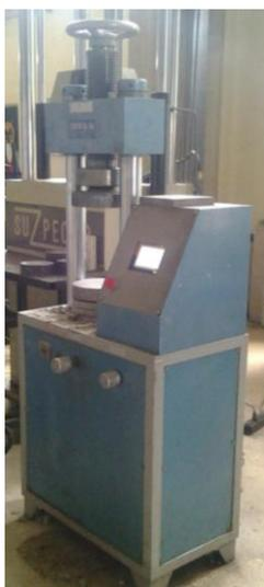
Figura 58. Máquina de compresión del Laboratorio de Mecánica de Suelos y Análisis de Materiales de la Escuela Politécnica Nacional.
