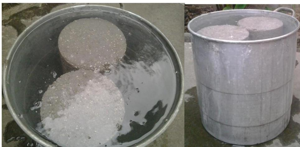
Figura 50. Muestras de hormigón fraguando
