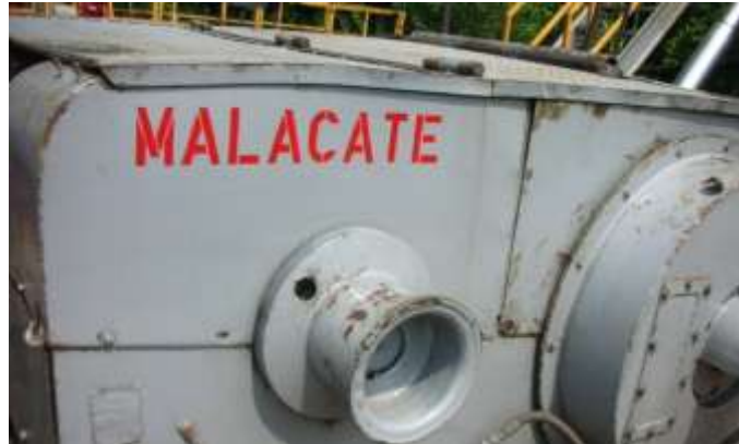
Figura 9. Malacate, equipo que enrolla y desenrolla el cable de acero, con el cual se baja y levanta la sarta de perforación.
