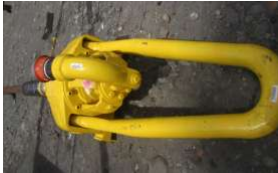
Figura 15. Swivel, componente de la torre para el proceso de reacondicionamiento de pozos.
