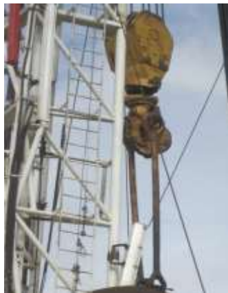
Figura 12. Bloque viajero y gancho, componentes de la torre de reacondicionamiento de pozos.
