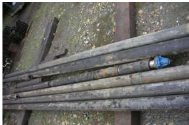
Figura 10. Sarta, toda la tubería y herramientas que se utilizan en el proceso de reacondicionamiento de pozos.
