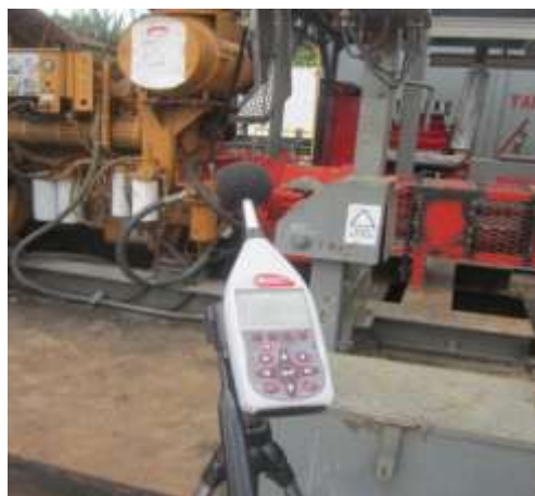
Figura 35. Sonómetro Quest Sound Pro SE DDL, colocado en un trípode para las mediciones de ruido en los diferentes puestos de trabajo.
