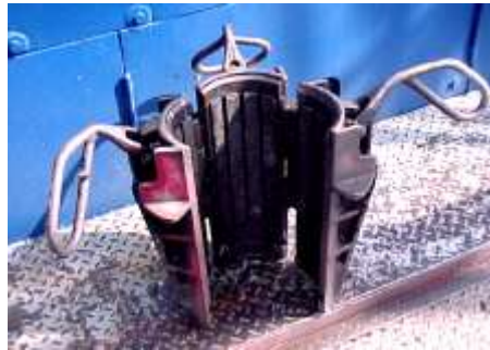
Figura 13. Cuñas, piezas de agarre que sujetan a la tubería.
