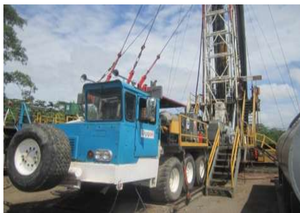
Figura 6. Carrier, unidad de movilización del taladro de reacondicionamiento de pozos.
