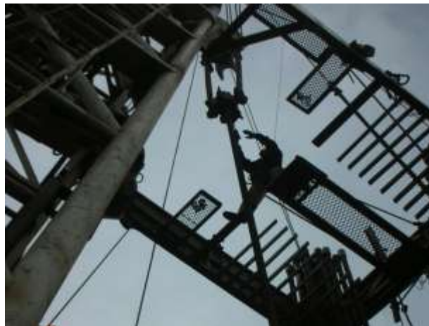
Figura 8. Segunda subestructura de la torre, lugar donde realiza el trabajo el encuellador.
