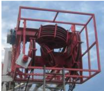
Figura 11. Bloque corona, poleas que se encuentran en la parte superior del taladro por el cual se moviliza el cable.
