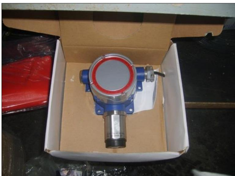
*Figura 27.* Detector de gas para diferentes tipos de gases (tóxicos/ inflamables) CG 710
