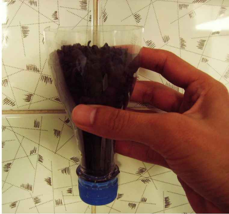
Foto 13: Embudo para flujo de agua en carbón activado
