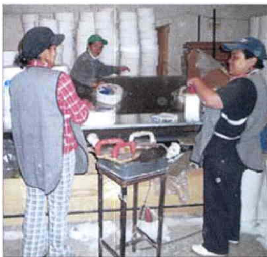
Figura 23. Planchas de teflón, utilizadas para el sellado del empaque de plástico
