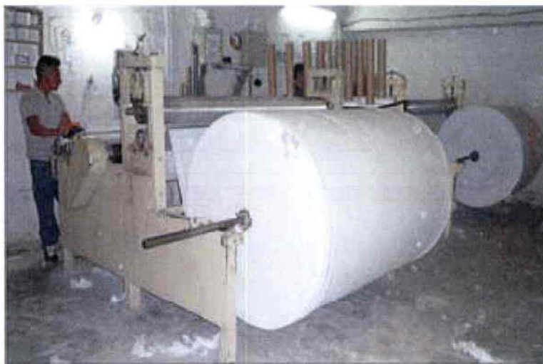
Figura 21. Máquinas rebobinadoras de papel higiénico de Convertidora de Papeles Ecuador Javier & Paulina Cía. Ltda.
