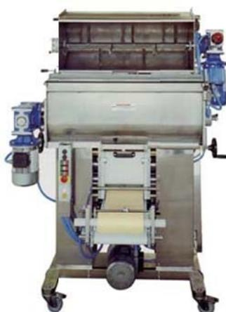
Laminadora automática de pastas con doble tolva mezcladora. Este conjunto laminador esta compuesto por tres juegos de rodillos con un contorno de surcos patentados, dando una única masa con un acabado sedoso.
