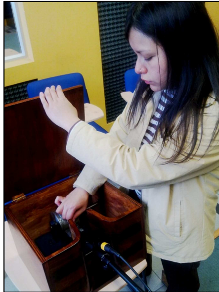
Foto 4.3: Mediciones de las frecuencias de cada una de las lengüetas.
