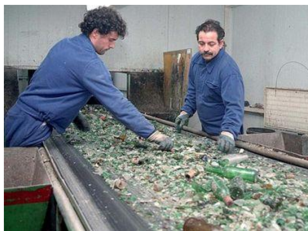
Figura 22: Limpieza del vidrio
