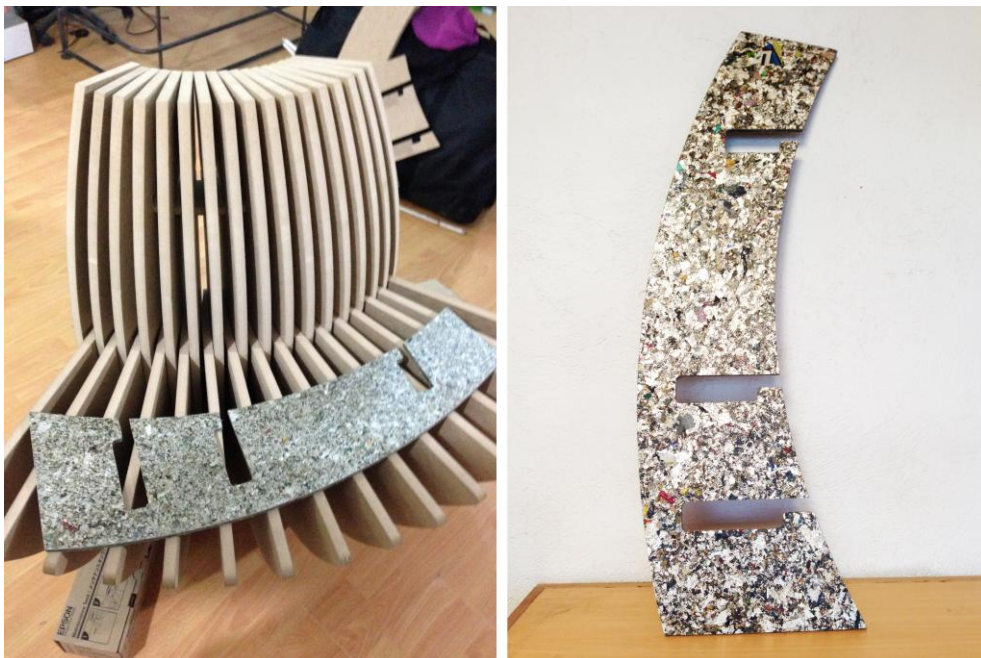
Figura 129. Verificación del maquinado de los tableros de polialuminio
