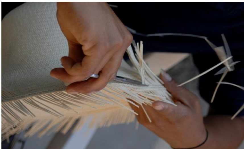
Figura 48. Cortando sobras del remate.
