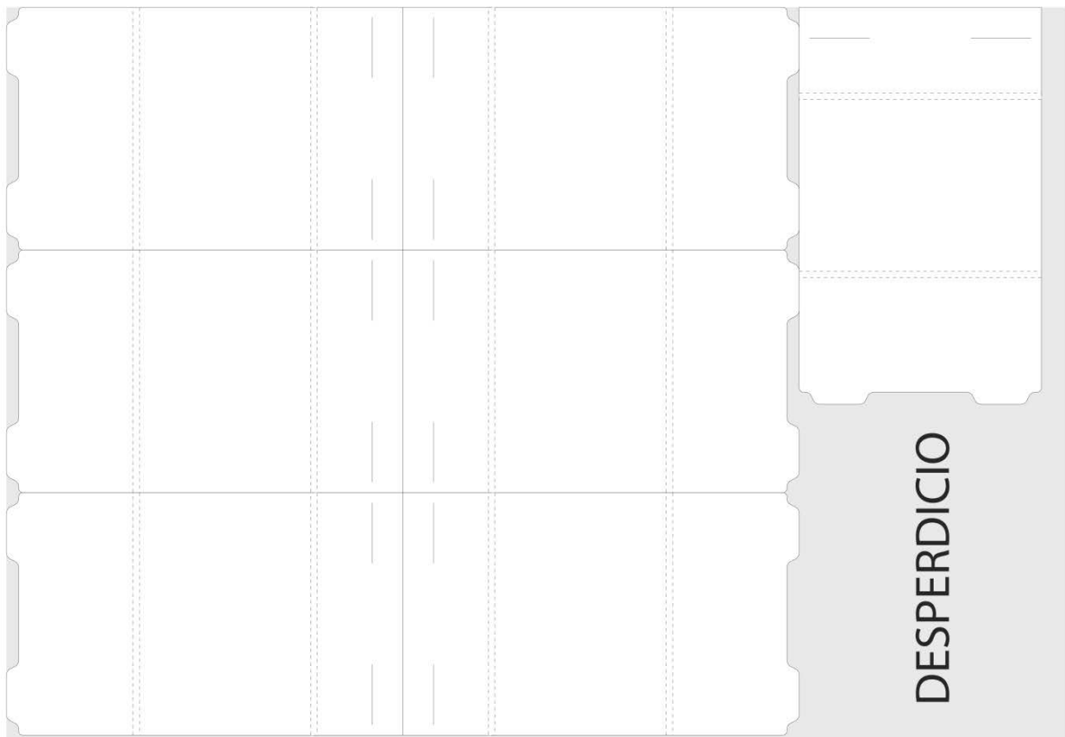
Figura 49. Número de empaque que caben en un pliego de papel kraft de 130x90 cm.
