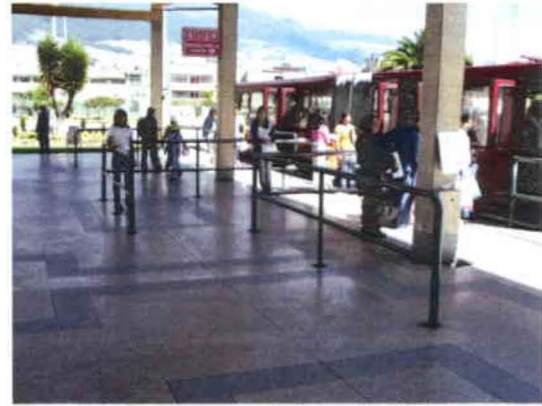
Divisores de fila que desperdician espacio del andén (Estación Río Coca)
