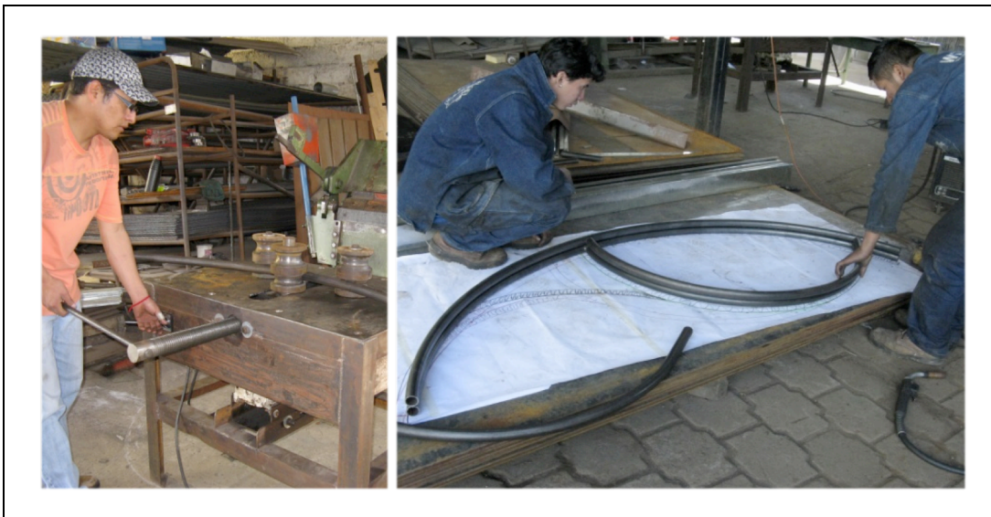
Gráfico 5.36 Proceso de construcción (varolado y armado) Elemento de sujeción integral
