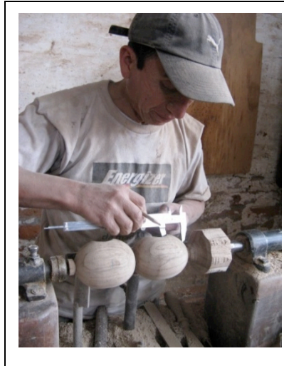
Gráfico 5.28 Proceso de torneado / Verificación de medidas
