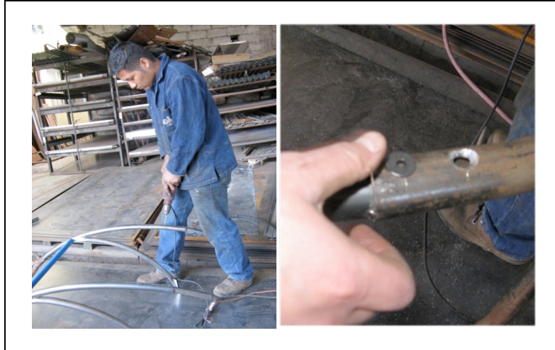
Gráfico 5.39 Perforado para acople por perno avellanado
