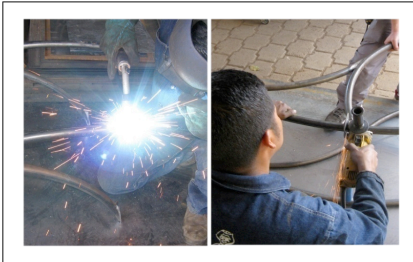
Gráfico 5.37 Proceso de suelda de componentes y pulido de bordes
