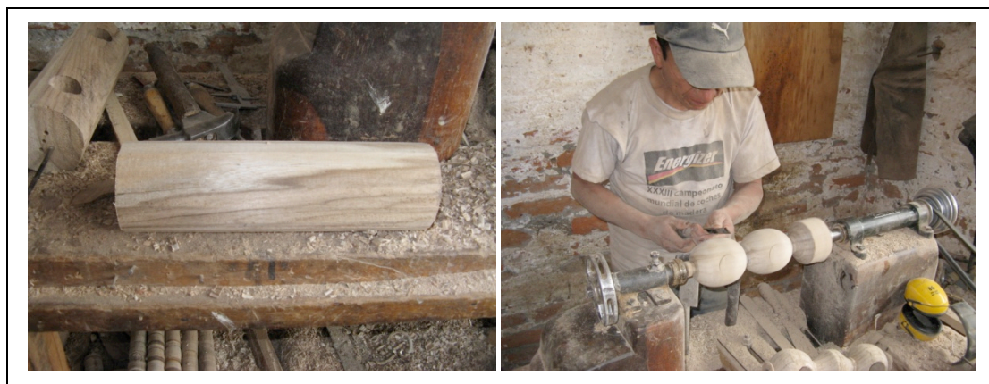
Gráfico 5.27 Proceso de torneado de la porción de madera de las manijas hamaca
