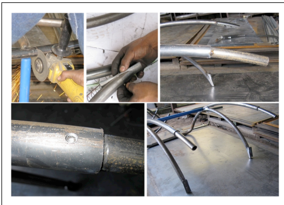
Gráfico 5.38 Proceso de corte en dos componentes y armado de acoples
