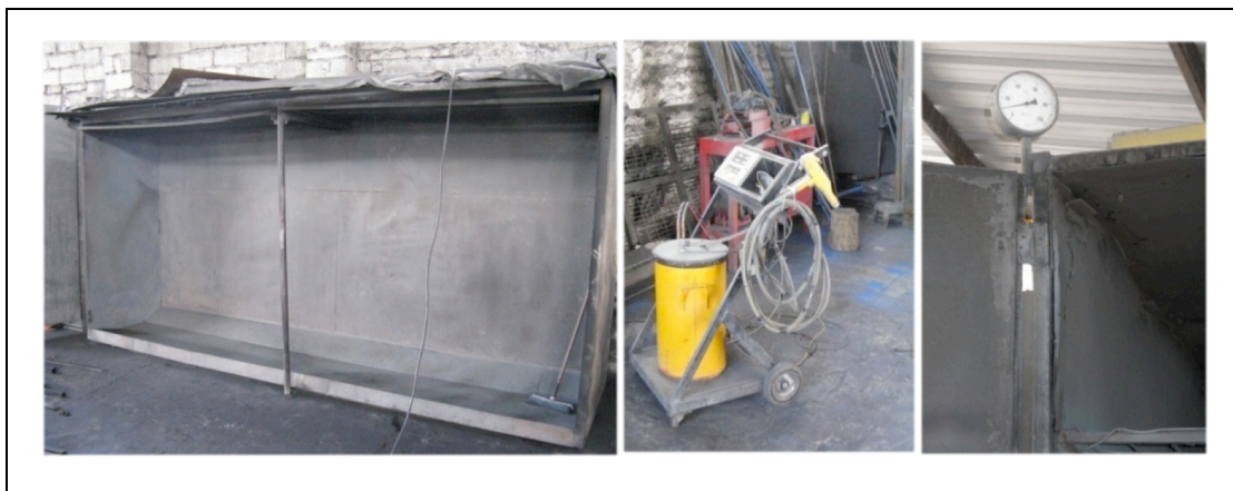
Gráfico 5.40 Instalaciones y equipos para aplicación de pintura electrostática
