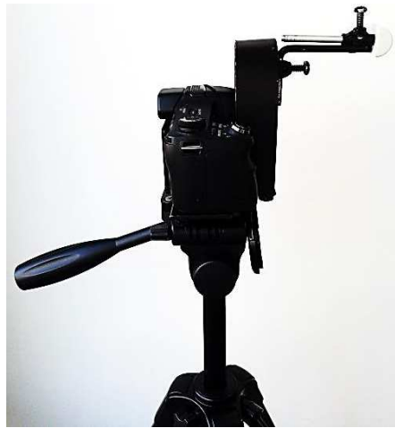
Figura 10. Pieza metálica para estandarizar distancia y posición de la toma fotográfica intraoral.
