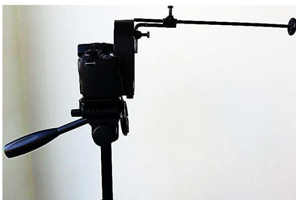
Figura 9. Pieza metálica para estandarizar distancia y posición de la cabeza.
