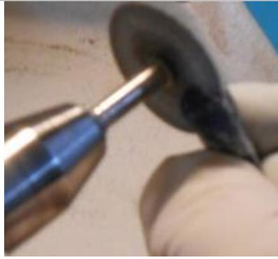
*Figura 17. Sección longitudinal de especímenes con máquina de pulir de cromo- cobalto FOSTER ALLOY GRINDER AGO4 9478 y DISCO DE DESBASTE ACERO Y METAL 3M.*
