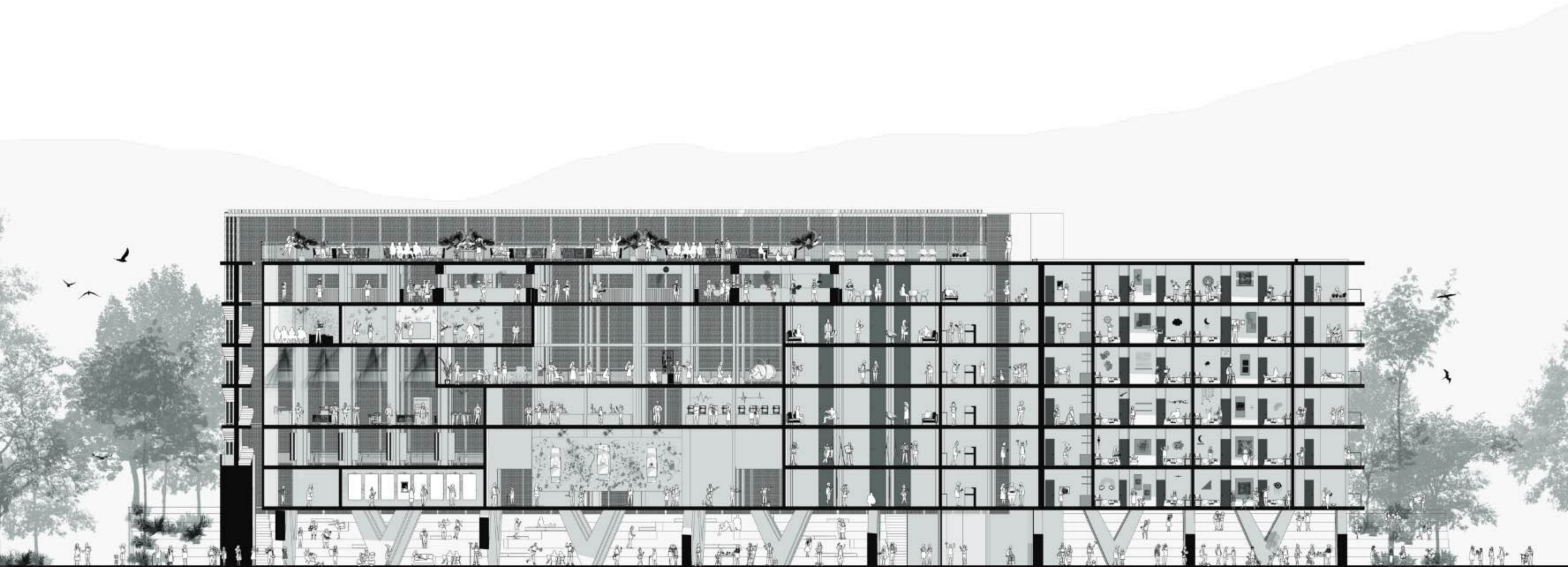
Fig. 73 Corte Longitudinal Arquitectónico. Fuente: Elaboración Propia
