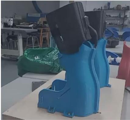
Figura 8. Resultado de la impresión 3D en PET-G
