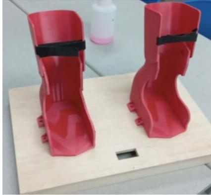
Figura 7. Resultado de la impresión filamento PLA
