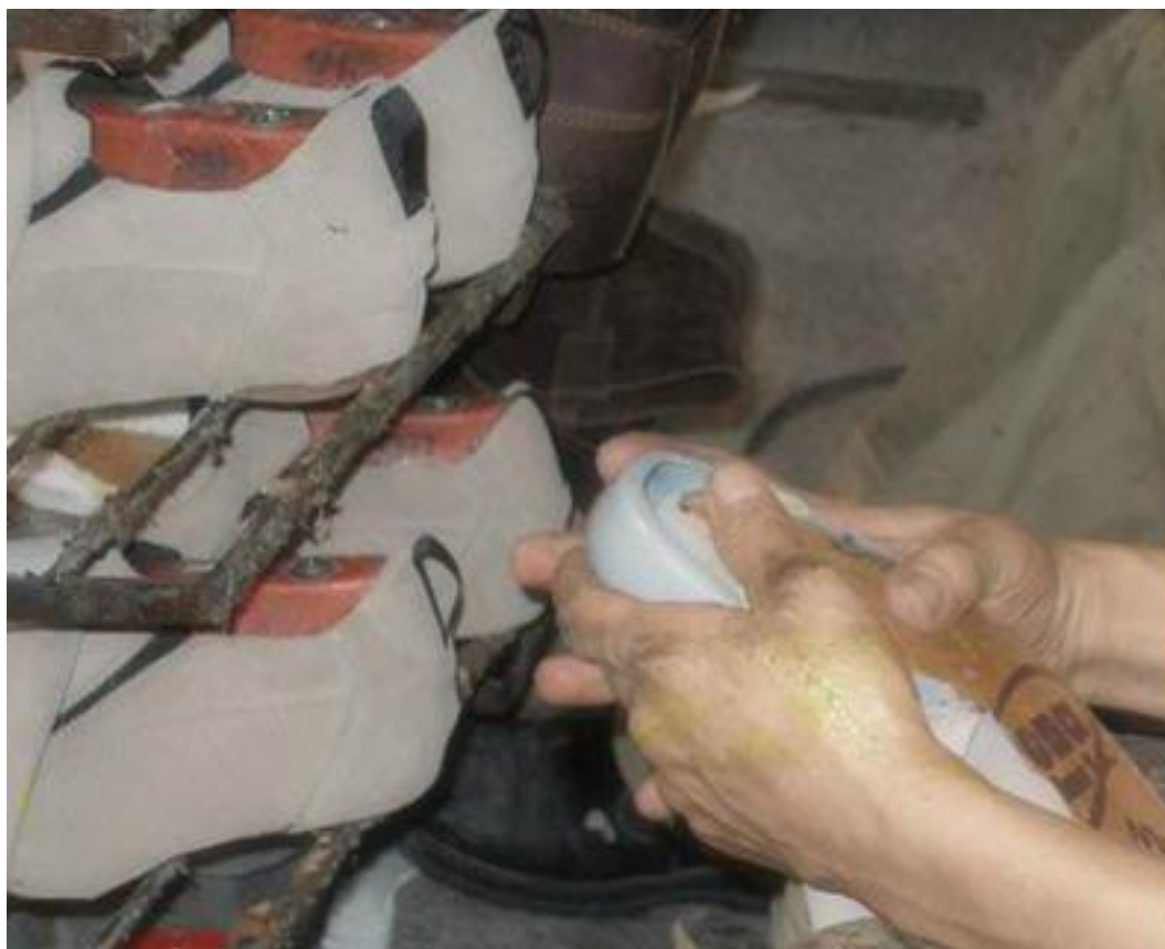
Figura 25. Armado de Capelladas
