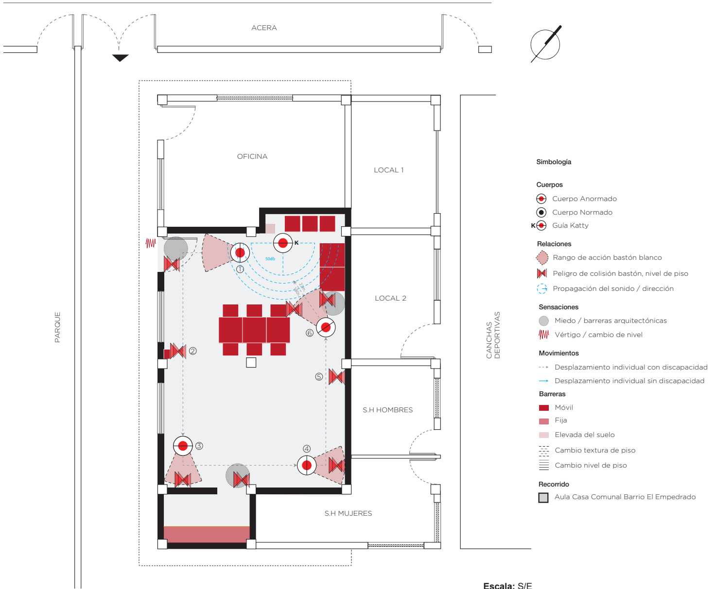
Cartografía. 6, Barrera fija, colisión con puerta y desnivel de piso.
