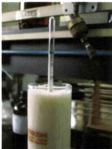
Fotografía 2.18: Lactodensímetro con termómetro incorporado.
