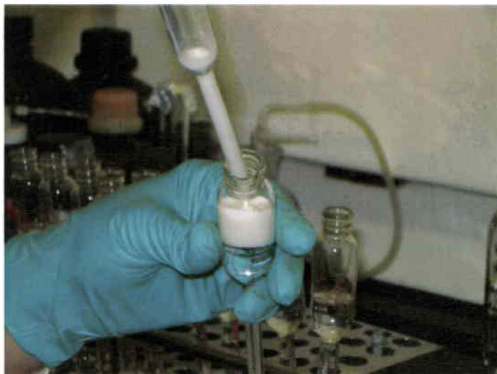
Fotografía 2.11: Leche con ácido sulfúrico en butirómetro.
