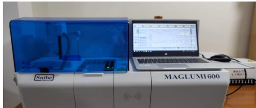
**Fotografía 14,15 y 16. Tomada por investigadoras en el momento del procesamiento y calibración automática de muestras de sangre por el método de MÉTODO QUIMINOLUMINISCENCIA en el EQUIPO MAGLUMI 600.**
