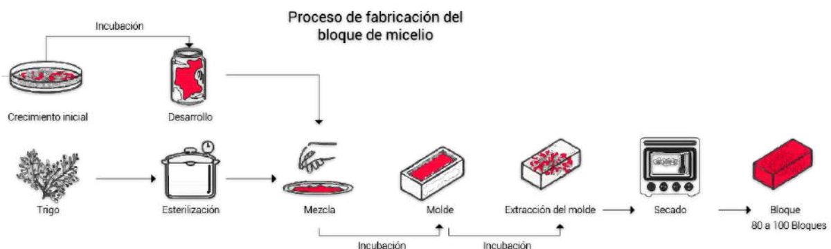
Figura 40. Diagrama, autoría propia. Diagrama del método de elaboración de un bloque de micelio.
