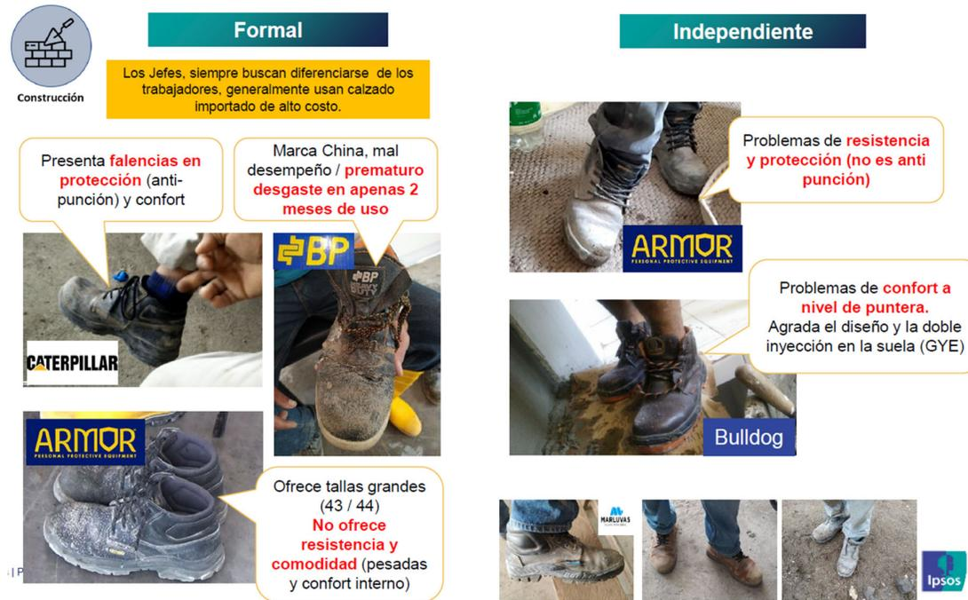
Figura 13: Durabilidad y mantenimiento del calzado de seguridad industrial
