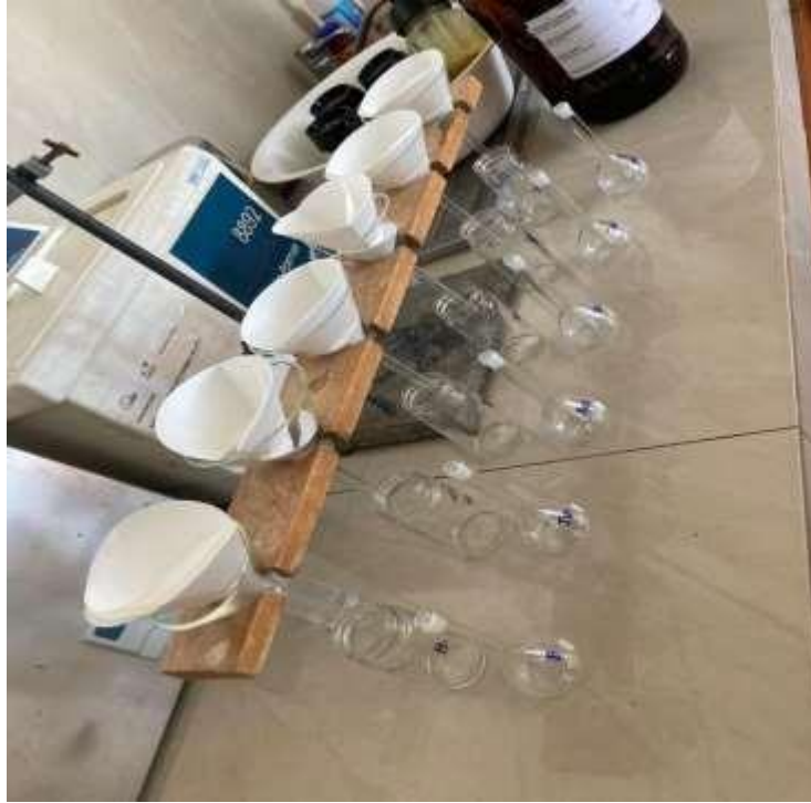
Figura 2. Extracción de solución de balanceado para fumonisinas B1 y B2 con las 4 etapas de crecimiento y su repetición
