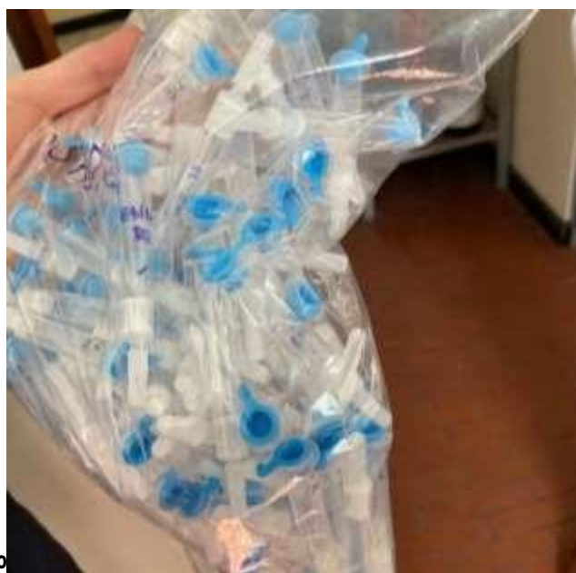
Figura 1. Columnas para determinación de fumonisinas B1 y B2
