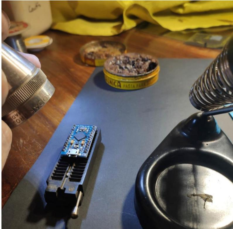
**Figura 21.** Soldando la placa Pro Micro a los pines.
