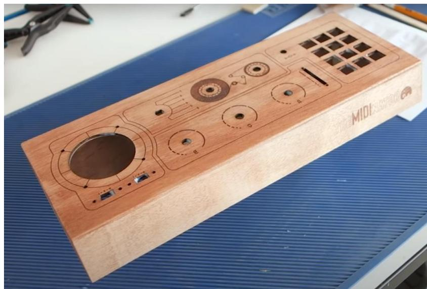
**Figura 2.** Carcasa impresa en madera para el dispositivo de Daniel Jansson. Tomado de (Jansson, 2019)
