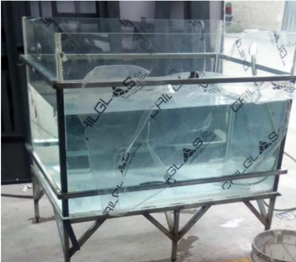
Figura 7. Pruebas es estanqueidad, tanque lleno de agua al 70%.
