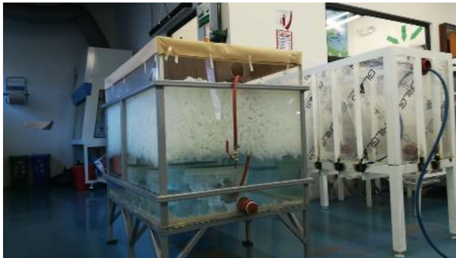
Anexo 8. Tanque reactor realizando pruebas hidráulicas, agua y soporte
