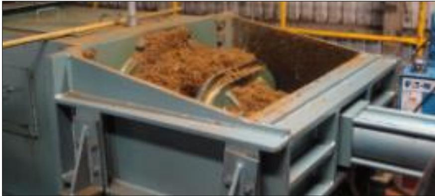
*Figura 22.* Máquina prensadora de la fruta de palma.
