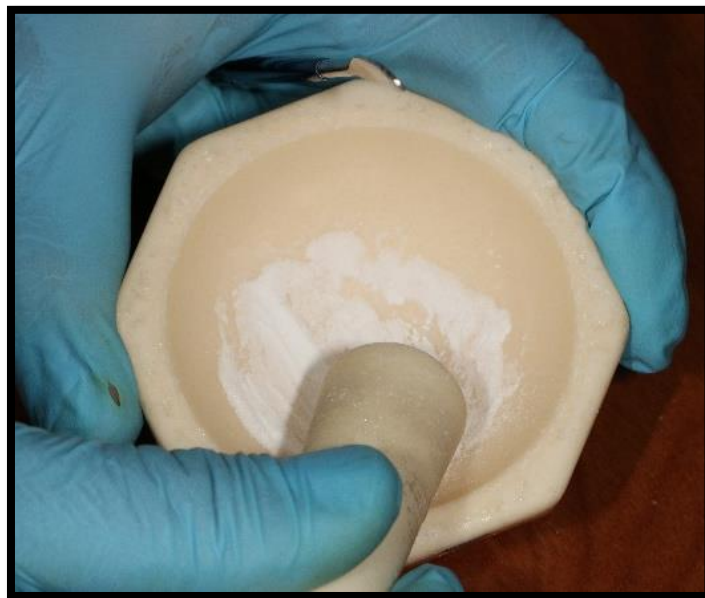
Figura 8 Pistilo mortero: mezcla de bromuro de potasio con resina
