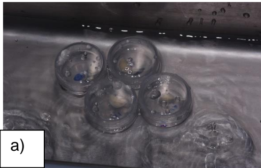
Figura 15: Muestras en ultrasonido con agua destilada.
