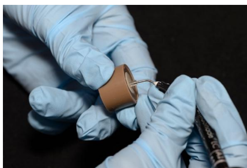
Figura 3. Inserción de cemento resinoso dentro de tubos tygon.
