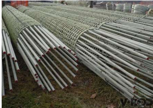
Figura 62: Pilotes de estructura vibra de vidrio
