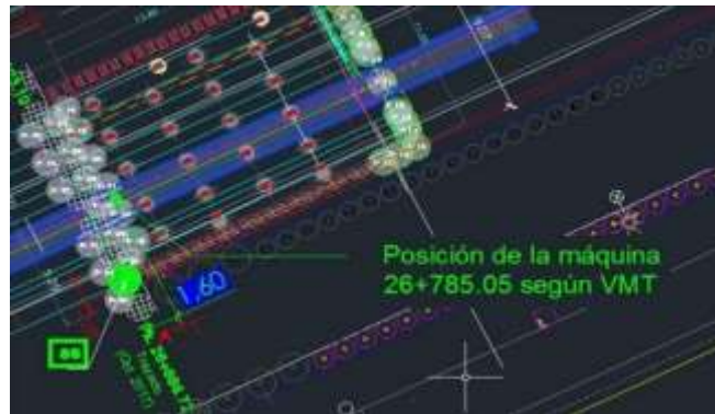
Figura 58: Corralito de pilotes salida de tuneladora
