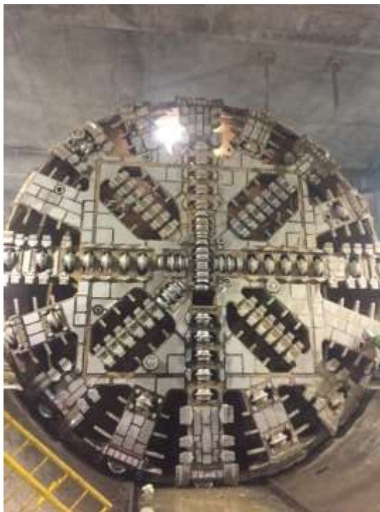
Figura 9: Rueda de Corte Maquina TBM
