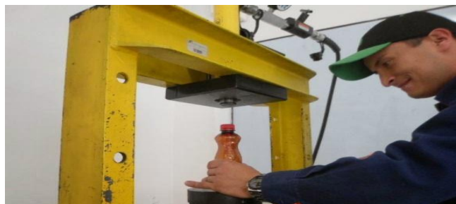
Figura 15 Prueba de resistencia a la botella vacía Tomado de: bedoya, 2014
