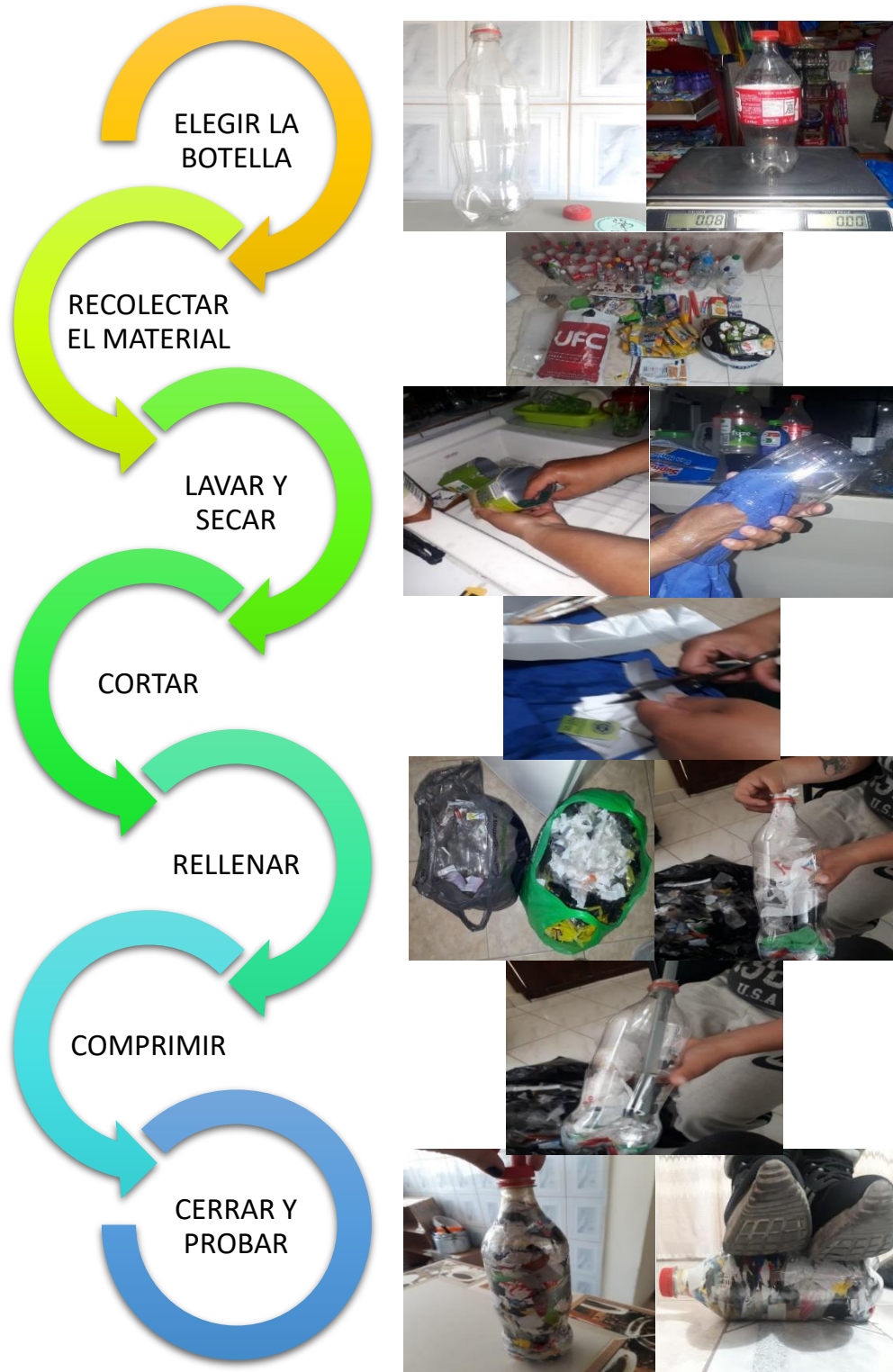
Figura 71 Construcción del prototipo
