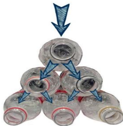
Figura 21 Distribución horizontal de las botellas
