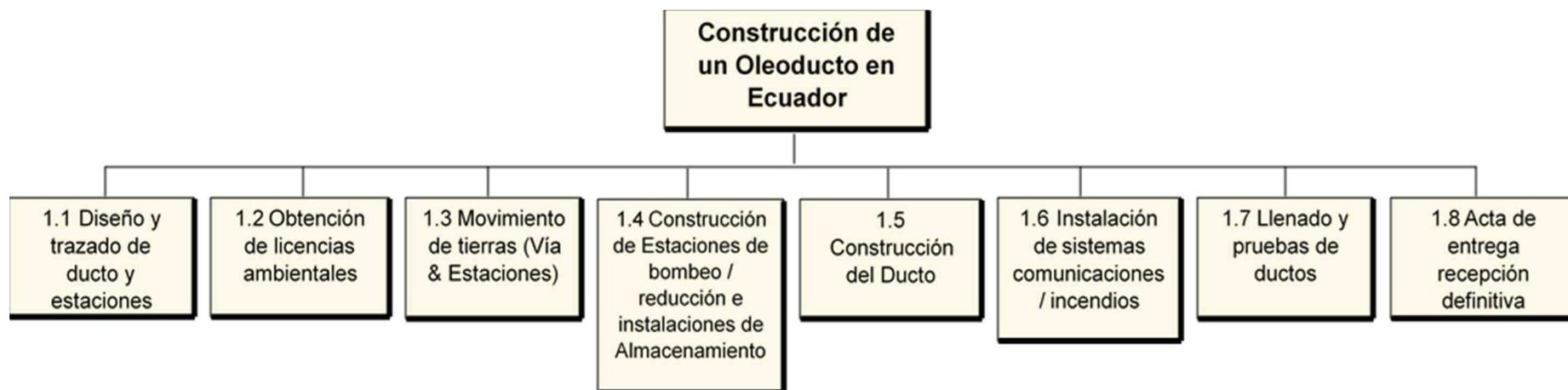
Figura 29. Modelo de construcción de un oleoducto en Ecuador - WBS
