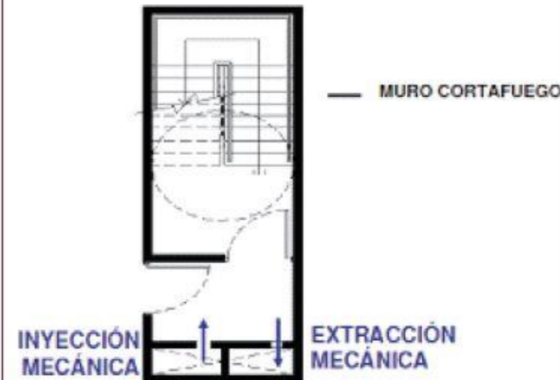
Figura 22. Detalle de gradas presurizadas. NEC_ Contra Incendios (2019).
