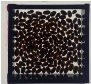
Figura 14: Imagen digital del trigo con 13 % de humedad.
