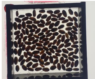
Figura 12: Imagen digital del trigo con 11 % de humedad.
