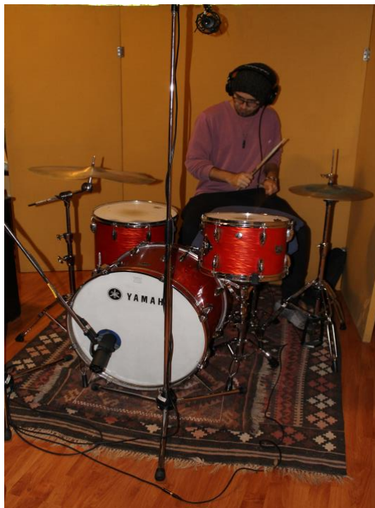
Figura 2. Ubicación de micrófonos para grabar baterías
