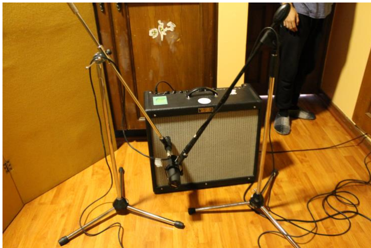
Figura 8. Amplificador armado con un Shure SM57 y un Shure SM7B
