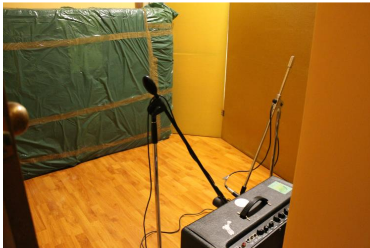
Figura 7. Acondicionamiento acústico usado para grabar guitarras
