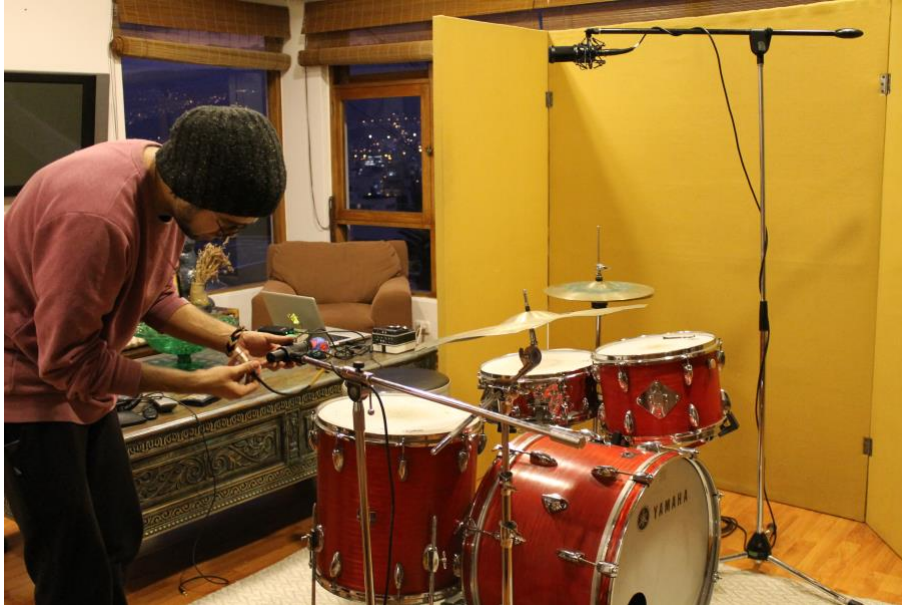
Figura 6. Ubicación de micrófonos técnica Glynn Johns
