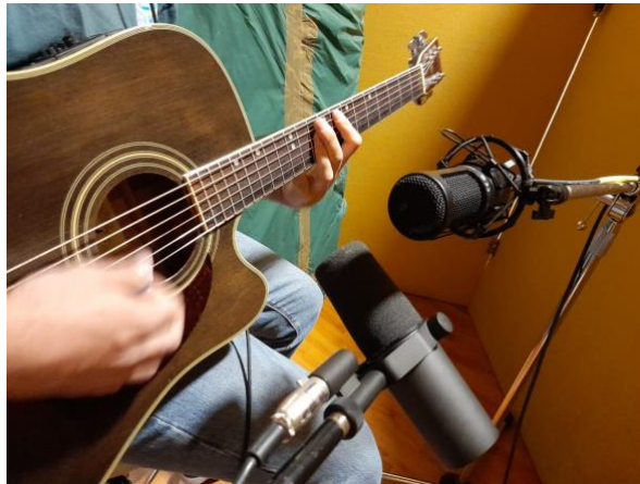
Figura 11. Ubicación de micrófonos AT2020 y SM7b para guitarras acústicas
