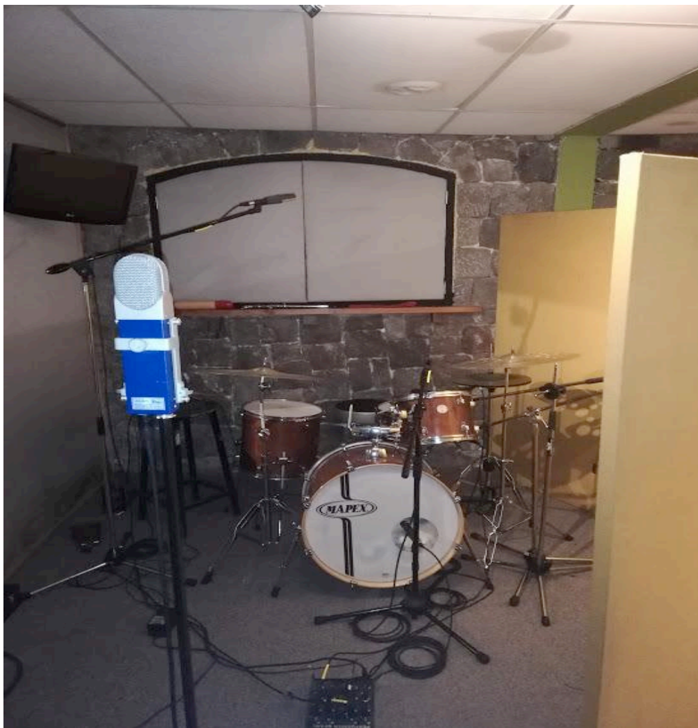
Figura 8, Set completo y condensador Blueberry para Room Mic
