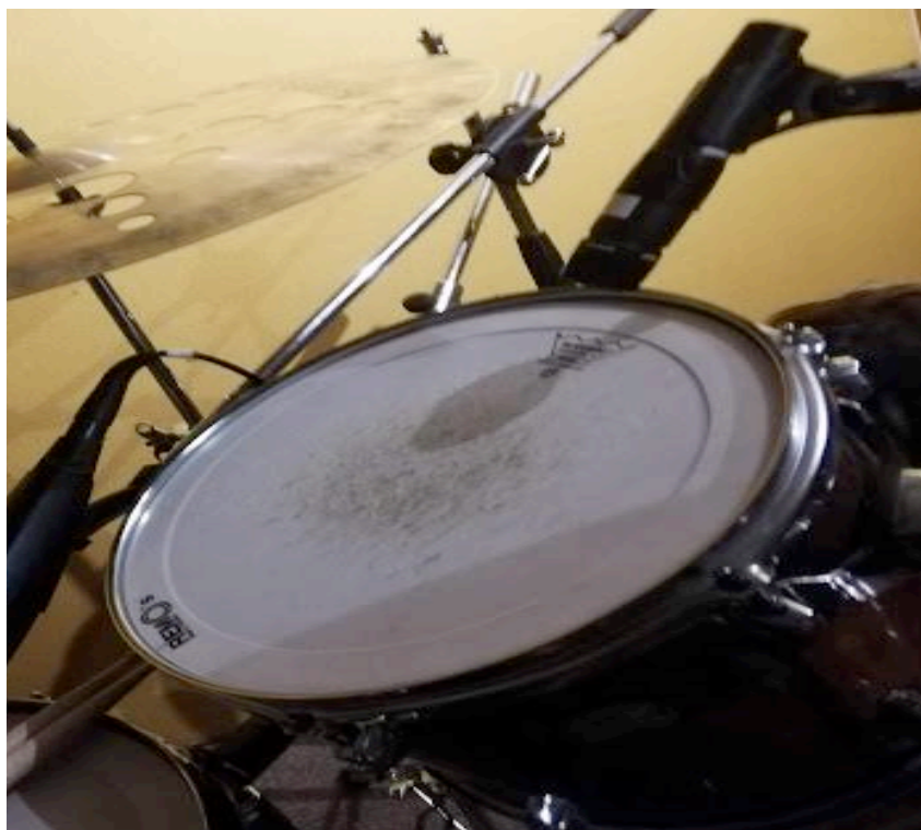
Figura 5, Rack Tom con SM57 Off Axis
