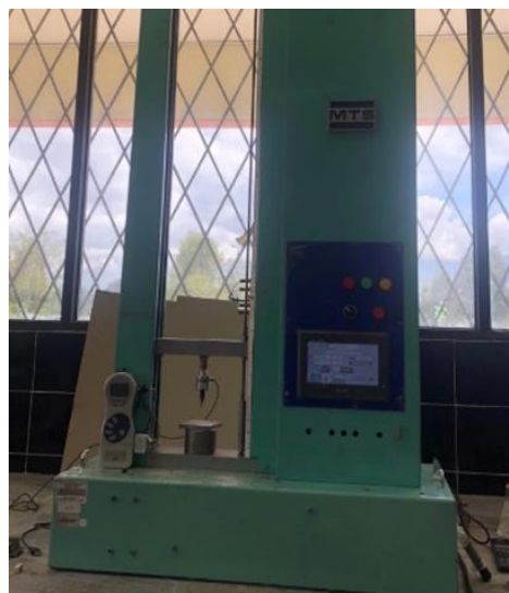
Figura 22. Máquina de ensayos universales MTS T5002
