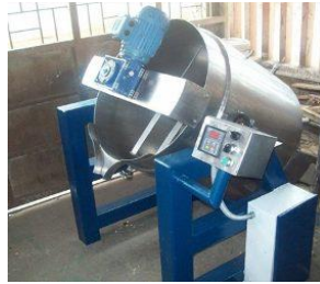
Figura 9. Pasteurizadora de 500 litros. Tomado de: (Google, 2019)
