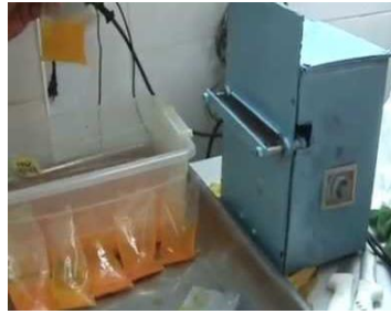
Figura 11. Máquina para sellado de pulpa de fruta. Tomado de: (Google, 2019)
