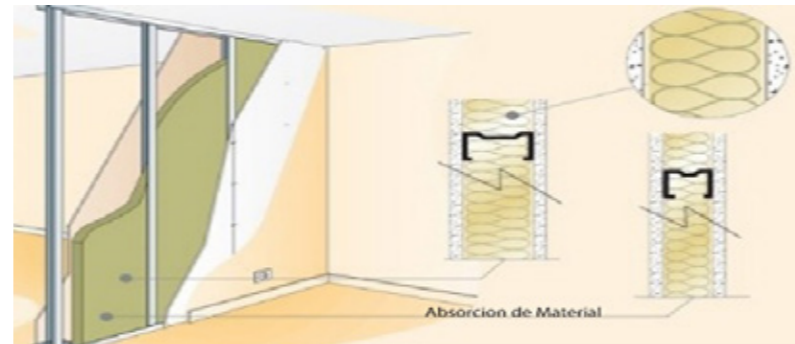
Figura 67. Absorción de Material Tomado. Acondicionamiento con absorbentes, difusores 2018
