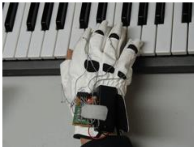
Figura 15. Guante utilizado para aprendizaje de piano.
