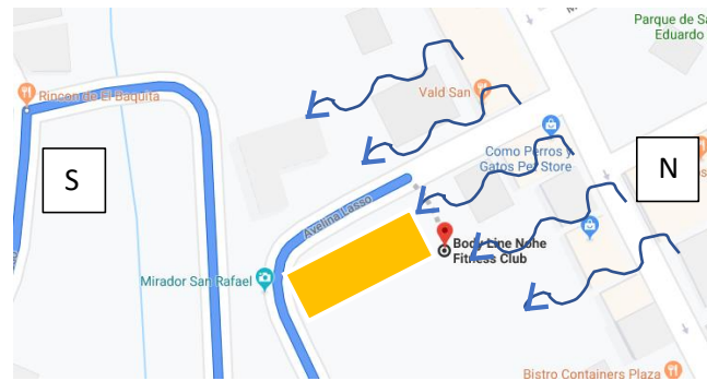
Figura 73. Dirección del viento en la edificación
