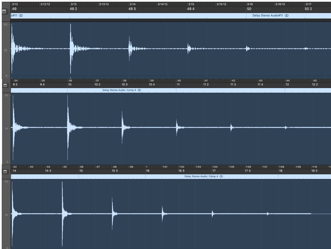
Figura 64. Resultados de pruebas de tiempo de retardo modo libre (1, 2 y 3 segundos de retardo del eco).
