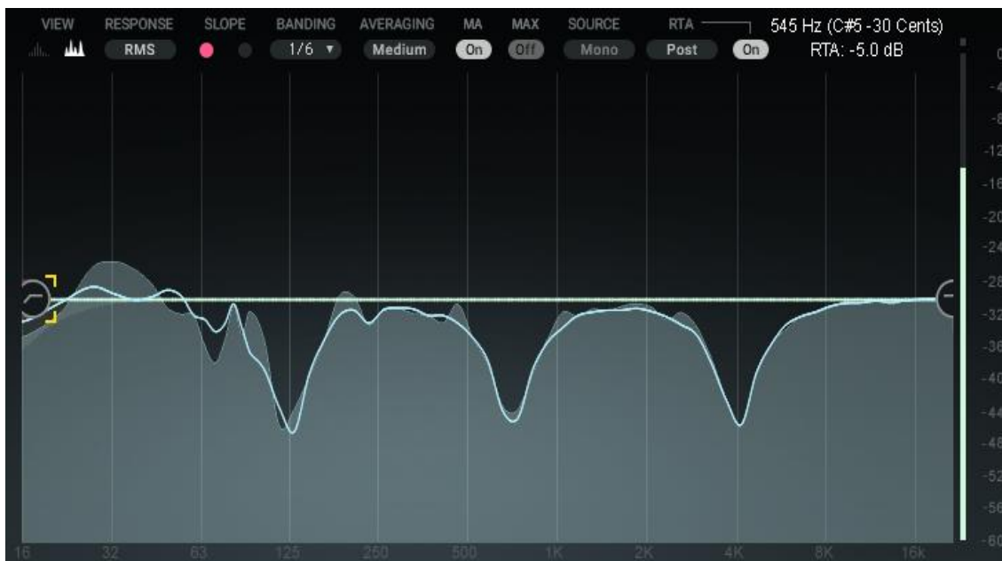
Figura 57. Implementación de los tres filtros peak con ganancia máxima negativa.
