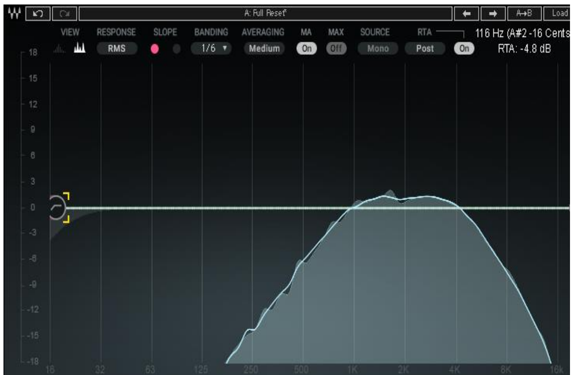
Figura 55. Orden de los filtros de paso del ecualizador. Frecuencia de corte del filtro de paso alto: 1 kHz. Frecuencia de corte del filtro de paso bajo: 4 kHz.
